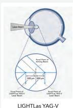
LIGHTLas YAG-V ±500 µm Posterior/ Anterior Offset
